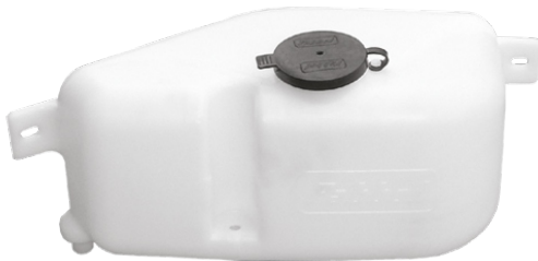
RESERVATORIO LIMPADOR PARA-BRISA MB 1620/1418/1218 COM TAMPA APLICAÇÃO: MB 1620/1418/1218/1622/1938L/S CÓDIGO PRODUTO: 0050005 CODIGO FÁBRICA: RP020
