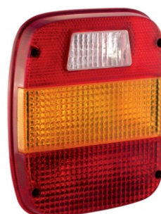
LENTE TRASEIRA VW/FORD TRICOLOR APLICAÇÃO: VW(1989 A 2011) CÓDIGO PRODUTO: 0010008 CODIGO FÁBRICA: PL04410009
