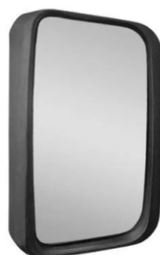
RETROVISOR SCANIA 114/124 SERIE 4 S/ DESEMBAÇADOR LE/LD APLICAÇÃO: SCANIA T/R 114/124 E SCANIA P/G/R SERIE 4 CÓDIGO PRODUTO: 0060028 / 0060029 CODIGO FÁBRICA: ER1024 / ER1025
