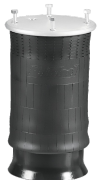
BOLSA SUSPENSÃO EIXO CARRETA RANDON APLICAÇÃO: CARRETA RANDON ATE 2005 CÓDIGO PRODUTO: 0040023 CODIGO FÁBRICA: AS4005
