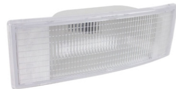
LANTERNA DIANTEIRA POSIÇÃO VOLVO FH CRISTAL APLICAÇÃO: VOLVO FH 1996 A 2004 CÓDIGO PRODUTO: 0010061 CODIGO FÁBRICA: PL17100022
