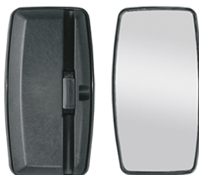
RETROVISOR VW TITAN PLANO 3/4 19MM APLICAÇÃO: VW DELIVERY 5.140/8.120/8.150/9.150 / WORKER 17.210/18.310/31.310/23.220 CÓDIGO PRODUTO: 0060012 CODIGO FÁBRICA: ER1032
